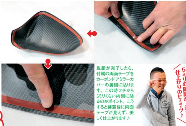
脱脂が完了したら、付属の両面テープをカーボンドアミラーカバーの裏側に貼ります。この時フチから5ミリくらい内側に貼るのがポイント。こうすると装着後に両面テープが見えず、美しく仕上がりますよ!
