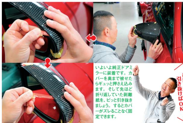
いよいよ純正ドアミラーに装着です。カバーを奥まで被せたらギュッと押さえ込みます。そして先ほど折り返していた剥離紙を、ピッと引き抜きましょう。するとカバーがスレることなく固定できます。
