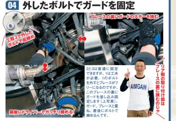
ステンレス製の燃料タンクガード。 燃料タンクの破損は致命傷に繋が るので、干渉しているクルマはこれ でガッチリ保護しておくと安心。対 応車種は18/200系のクラウンとマ ジェ。いずれもボルトオンで付く。
