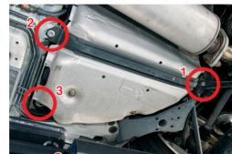
と、1のボルトが姿を表すはず。これを含 ト3木をドライバーで してください。 な 1と2は14ミリのボ ルトで、3は12ミリの ナット。それぞれ対 応するドライバーで 外してくださいね。
