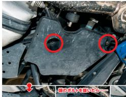
まずは右側(運転席 側) から装着します が、燃料タンクのや や後ろにある黒い樹 脂パネルを外すのが 第一。ガードを取り すけるボルトがこの パネルで隠れている からです。このパネ ルは赤マルの10ミリ ボルトで固定されて いるので、ドライバー で抜き取りましょう。
