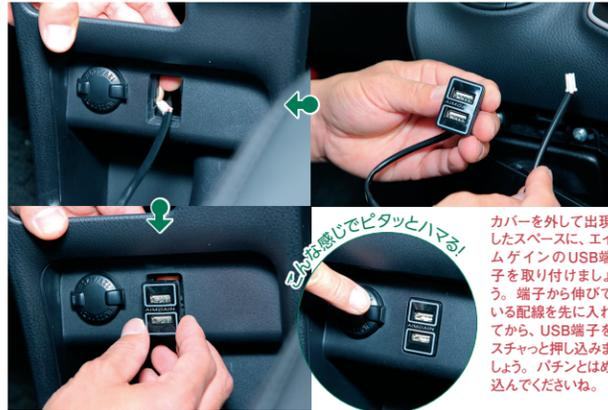
カバーを外して出現したスペースに、エイムゲインのUSB端子を取り付けましょう。端子から伸びている配線を先に入れてから、USB端子をスチャッと押し込みましょう。パチンとはめ込んでください。
