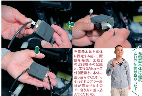
充電器本体を車体に固定する前に、配線を接続。工程2のUSB端子の配線と、工程3のヒューズ付き配線を、本体に差し込んでください。それぞれカプラー形状が異なりますので、合う方に差し込んでください。
