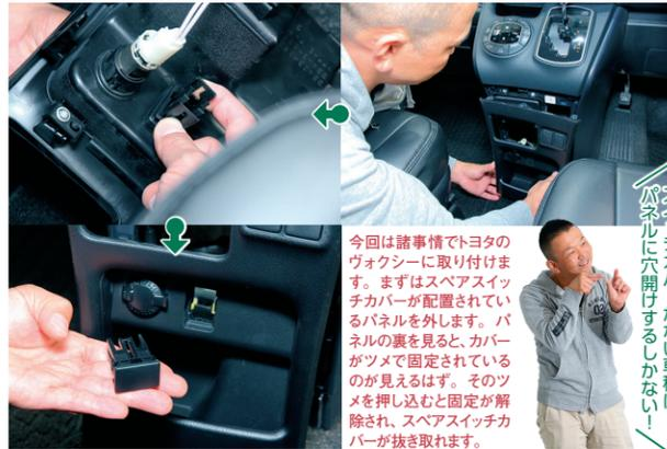
今回は諸事情でトヨタのヴォクシーに取り付けます。まずはスペアスイッチカバーが配置されているパネルを外します。パネルがツメで固定されているのが見えるはず。そのツメを押し込むと固定が解除され、スペアスイッチカバーが抜き取れます。
