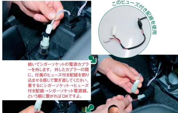
続いてシガーソケットの電源カプラーを外します。外したカプラーの間に、付属のヒューズ付き配線を割り込ませる感じで繋ぎ直してください。要するにシガーソケット→ヒューズ付き配線→シガーソケット電源線、という順に繋がればOKですよ。
