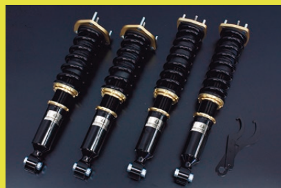
エイムゲインのセダンダンパー タイプLS。20IS用のバネレートはF14・R10キロで、ISの車重などを考慮してセッティングしている。
