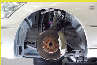
10万キロオーバーとなると、エアサスが少々心配な時期。写真のように車高調に交換するという手もある。
