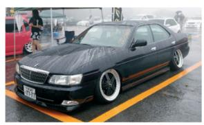
絶版の段リムのエキウップ。これを履かせている時点で注目度はかなりのもの。しかし、手に入れた当時は到底履かせられる状態ではなく、リムを研磨し、ディスク部分とセンターキャップ、ピアスボルトも塗装するなど、フルリペアを敢行。「Equip」の文字はゴールドにして目立たせる狙い。
