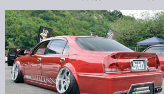
ミラーはエクストレイル用を流用。最新仕様のボンネ ットは、パテでIMC風にラインを入れて製作した。
