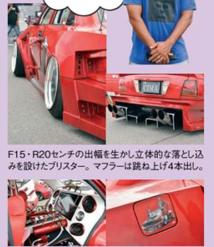
F15・R20センチの出幅を生かした立体的な落とし込みを設けたプリスター。マフラーは跳ね上げ4本出し。
