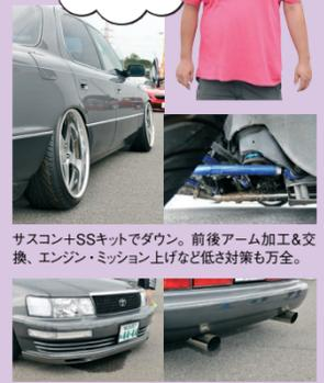
サスコン+SSキットでダウン。前後アーム加工&交換、エンジン・ミッション上げなど低さ対策も万全。
