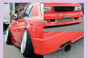
エアロはセッション。オパフェンはF4・R6センチの鉄板溶接で、F10・R12を飲み込む。アームもひと通り交換済み。ボディカラーはフェラーリレッド。
