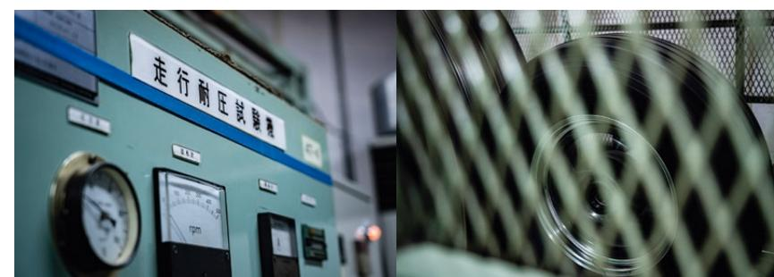
取材時は走行耐圧試験を実施していた。JWLの規格では50万回転で十分とされているが、SSRはより厳しい独自条件を追加した上で、それを上回る60万回転させる。ここまでやるからSSRの製品は絶対的な信頼性を誇る。
