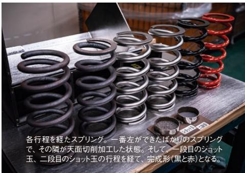
各行程を経たスプリング。一番左ができたばかりのスプリングで、その隣が天面切削加工した状態。そして、一段目のショット玉、二段目のショット玉の行程を経て、完成形(黒と赤)となる。
